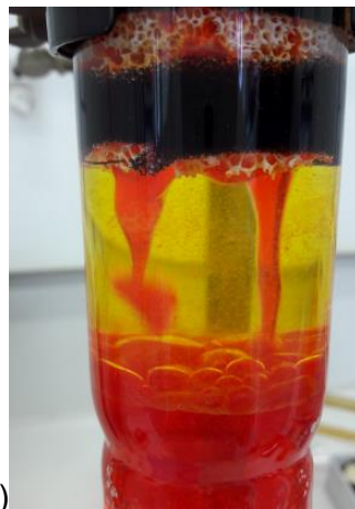
Abbildung 45 Strömungsverlauf der wässrigen Phase während der Extraktionsuntersuchungen; a) Strömungskanäle innerhalb eines Schaumelements sichtbar durch dunkel gefärbte Bereiche in einem Schaum; b) Strömung durch wenige Kanäle, sodass wenige, geschlossene Strömungspfade aus dem unteren Schaumelement austraten; c) Strömung durch viele Kanäle, sodass eine diskontinuierliche Tropfenströmung aus dem untersten Schaumelement ausfloss.
