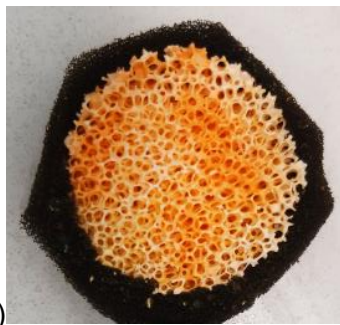
Abbildung 45 Strömungsverlauf der wässrigen Phase während der Extraktionsuntersuchungen; a) Strömungskanäle innerhalb eines Schaumelements sichtbar durch dunkel gefärbte Bereiche in einem Schaum; b) Strömung durch wenige Kanäle, sodass wenige, geschlossene Strömungspfade aus dem unteren Schaumelement austraten; c) Strömung durch viele Kanäle, sodass eine diskontinuierliche Tropfenströmung aus dem untersten Schaumelement ausfloss.
