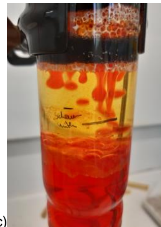
Abbildung 45 Strömungsverlauf der wässrigen Phase während der Extraktionsuntersuchungen; a) Strömungskanäle innerhalb eines Schaumelements sichtbar durch dunkel gefärbte Bereiche in einem Schaum; b) Strömung durch wenige Kanäle, sodass wenige, geschlossene Strömungspfade aus dem unteren Schaumelement austraten; c) Strömung durch viele Kanäle, sodass eine diskontinuierliche Tropfenströmung aus dem untersten Schaumelement ausfloss.
