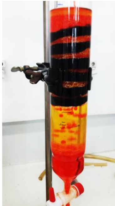
Abbildung 43 Fließverhalten während einer Extraktionsuntersuchung mit fünf „10 ppi-Schäumen“.
