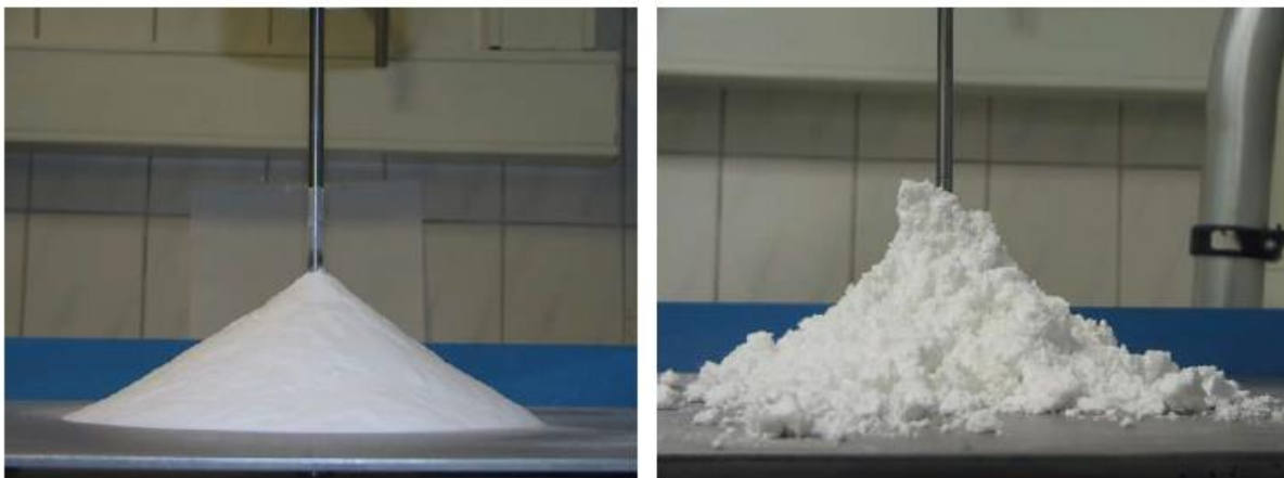
Abbildung 2-5: Einfluss des Wassergehalts auf den Böschungswinkel, Feuchtigkeitsunterschied 8,5 %
