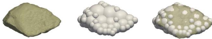
Abbildung 3-14: Approximation komplexer Formen durch Multispheres (entnommen aus [93])
