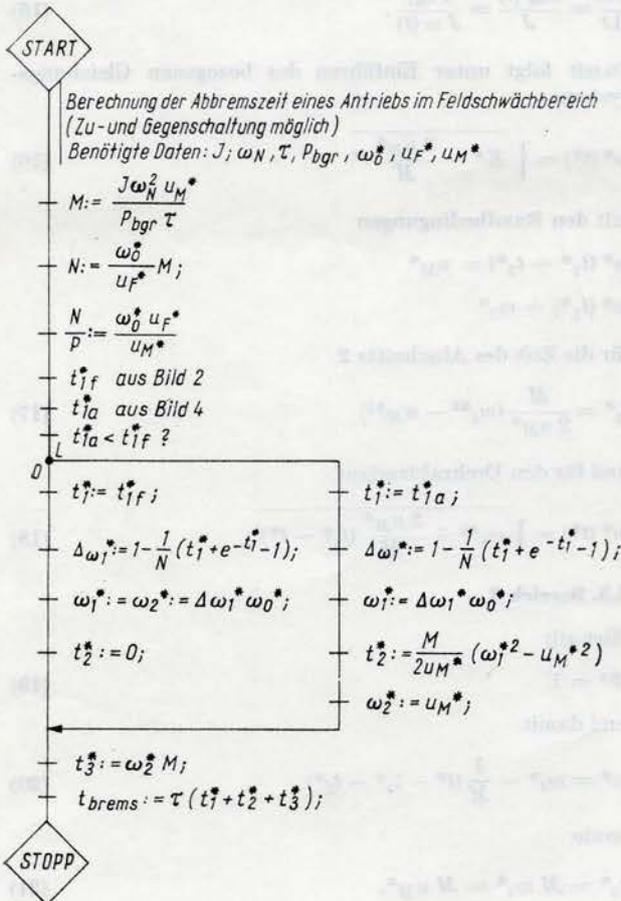
Bild 5. Flußdiagramm zum Berechnen der Abbremszeit
