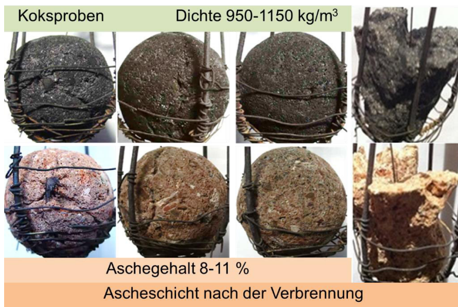
Abbildung 6-40: Koksproben vor und nach der Verbrennung.
