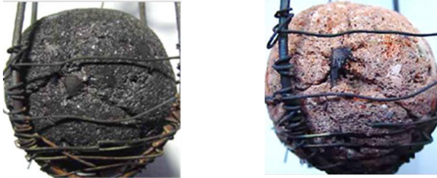
Abbildung 6-8: Koksprobe vor dem Versuch und Koksprobe mit Ascheschicht nach der vollständigen Verbrennung.
