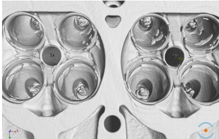
Abbildung 5-33:CT-Scan modellierte Brennrumfläche
