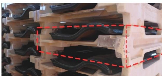
Abbildung 4-1: Vereinfachung des Ziegel- und Kassettensbesatzes durch ein Plattensystem (Fotos: Jacobi Tonwerke GmbH oben und BMI Technical Services GmbH unten)
