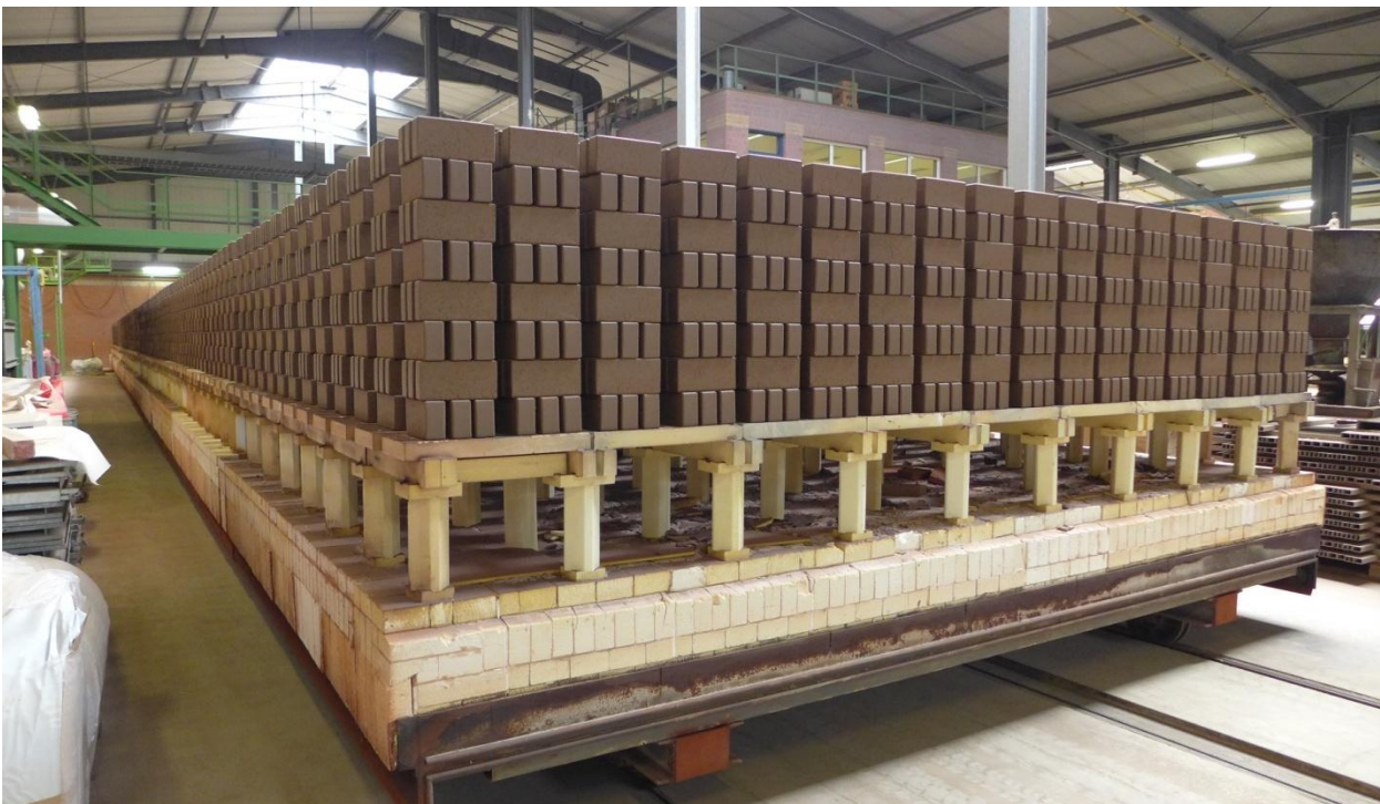
Abbildung 1-5: „Türmchenbesatz“ aus Klinker für die Seitenunterfeuerung (Foto: ABC-Klinkergruppe)
