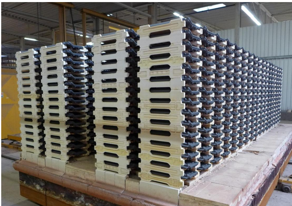
Abbildung 1-6: Dachziegelbesatz in horizontaler Ausrichtung (Foto: BMI Technical Services GmbH)
