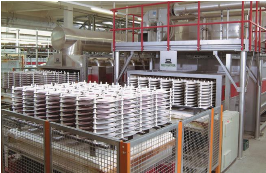
Abbildung 4-5: Schnellbrandofen für den Glasurbrand von Porzellan (Foto: Riedhammer GmbH)
