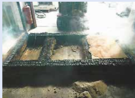
Prüfdecke nach Brandversuch
