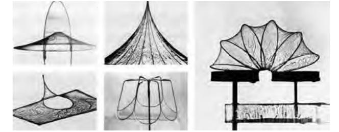
Experimenting with Soap Bubbles. Image: Institut für leichte Flächentragwerke (IL) der Universität Stuttgart
