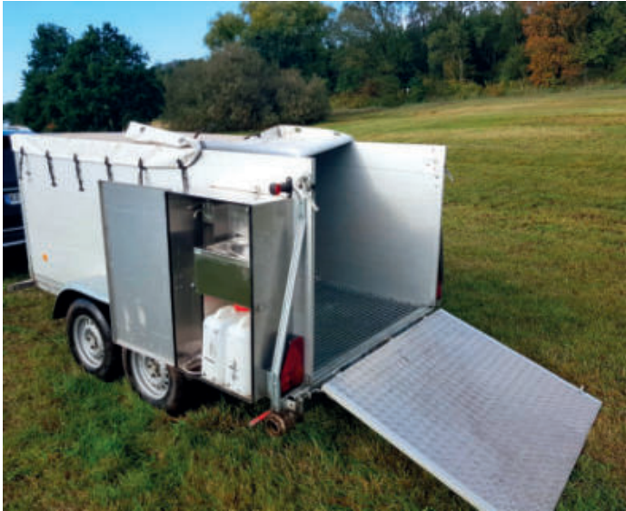
Flüssigkeitsdichter Transportanhänger mit Blutsammelwanne, © S. Reinhard
