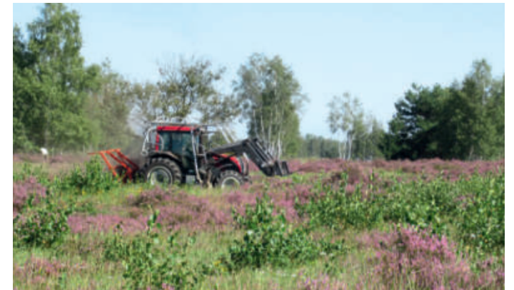
Mulchen von Gehölzwiederaustrrieben und Altheiden mit munitionsgeschütztem Traktor, © A. Lorenz
