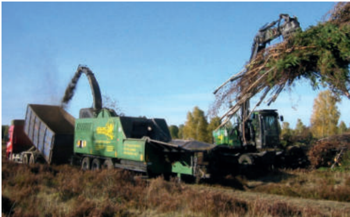
Entbuschung mit anschließender Hackung und Abtransport der Holzhackschnitzel, © A. Lorenz (o.), B. Felinks (M., u.)
