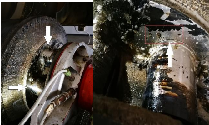
Abbildung 32: Zwei „Power Plates“ der Zentrifuge (links) Wehrdurchmesserskala an einem „Power Plates“ (rechts)
