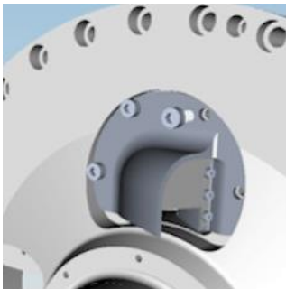
Abbildung 14: Power Plates [nach Technische Beschreibung Zentrifuge, Alfa Laval]
