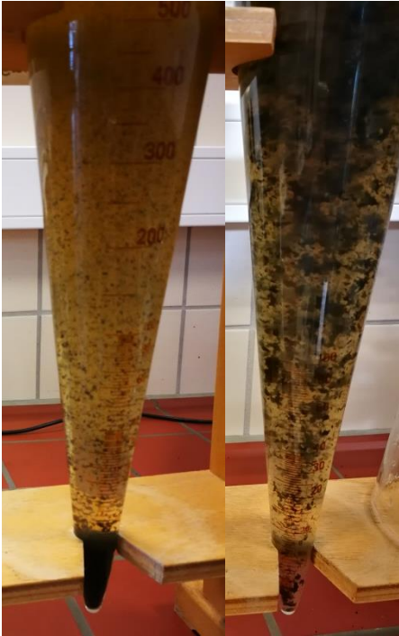
Abbildung 41: Flockenbildungstest links: keine Flockenbildung rechts: Flockenbildung durch zusätzliche Dosierung von FHM
