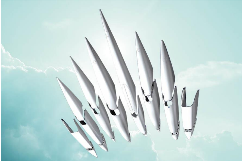
Abbildung 4: Struktur der Flap Track Fairings [2]
