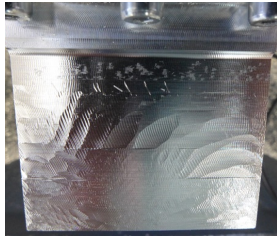
(b) Gegenlauf - „Wellenförmige“ Struktur durch Relativbewegung zwischen Werkstück und Werkzeug.
