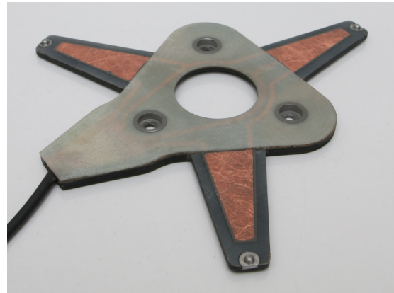
(b) Optimierte 3-Arm-Trägerstruktur aus CFK.
