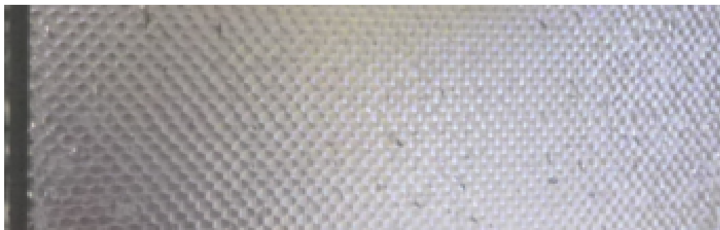
Abbildung 6.12: Gezielte Oberflächenstrukturierung mittels Werkstückakutierung als zusätzliche Anwendungsmöglichkeit der entwickelten Vorrichtungen.
