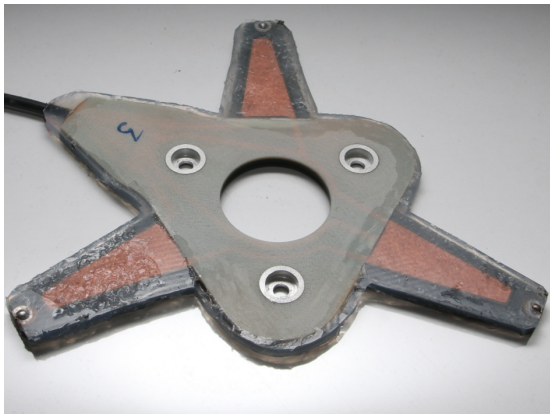
(c) Trägerstruktur aus CFK mit Silikon-Kapselung.
