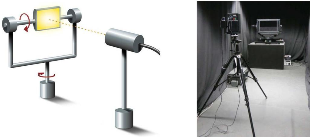
**Abbildung 4.5 (links): Schematische Darstellung eines Goniometertyps B [Ins19]**
