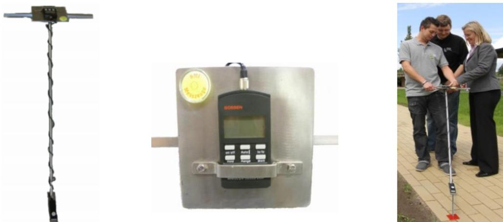
**Abbildung 5.5 (links): Beleuchtungsstärkemessinstrument und Stativ in der Frontansicht [eigene Aufnahme]**
