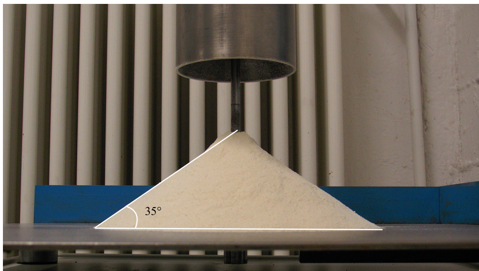
Abb. 4.20 – Experiment zur Bestimmung des statischen Böschungswinkels von Asparaginmonohydrat.
