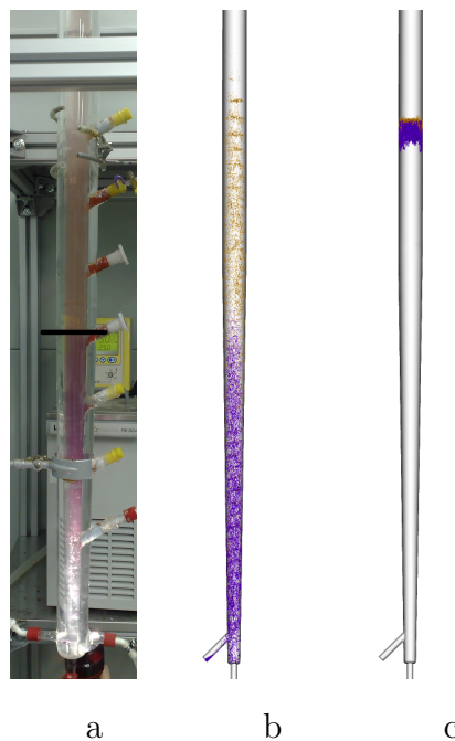
Abb. 4.2 – (a) - Experiment mit Glaspartikeln unterschiedlicher Farbe und Größe ( d_{m,violett} = 150 - 180 \mu\text{m} ; d_{m,orange} = 90 - 125 \mu\text{m} ), (b) - CFD-DEM-Simulation mit 100,000 Partikeln nach einer physikalischen Zeit von 30 s, (c) - Anfang der CFD-DEM-Simulation t = 2 \text{ s} .
