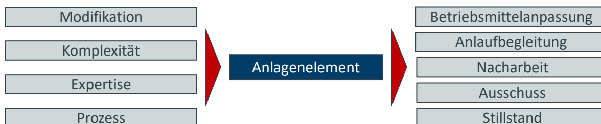
Abbildung 51: Ursachen technischer Projektrisiken im Anlagenbau
