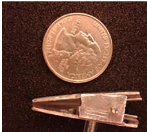
Abb. 3-6: Hydraulischer Greifer für Roboter in der minimal invasiven Chirurgie [1]
