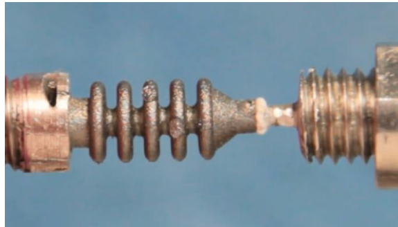
Abb. 5-19: Undichtigkeiten am konvexen Radius
