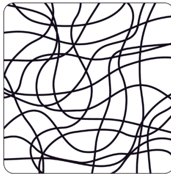
Abb. 4-11: Schematische Darstellung der fadenförmigen Molekülstruktur von Thermoplasten [80]
