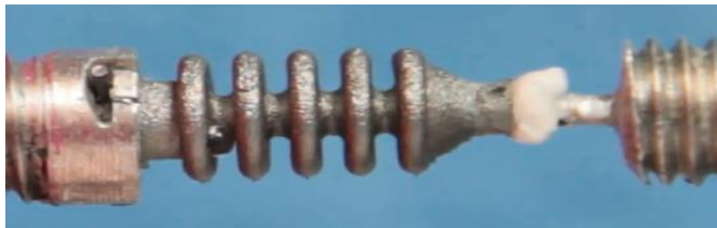
Abb. 5-20: Undichtigkeiten am konkaven Radius
