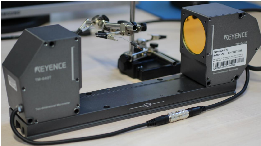
Abb. 5-16: Balgaktor platziert in zweidimensionalem Mikrometer zur lastfreien Vermessung
