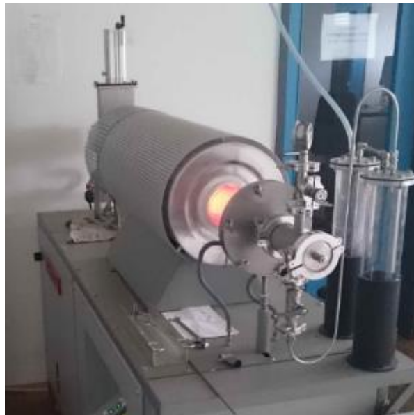
Abb. 4-27: Vakuumofen zur Wärmebehandlung der Nitinol Bauteile
