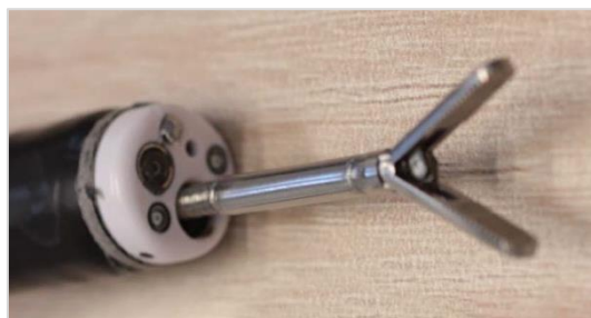
Abb. 3-4: Hydraulisches Greifinstrument in einem flexiblen Endoskop [12]
