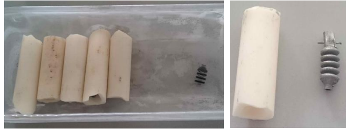
Abb. 4-26: Anordnung der generativ gefertigten Nitinol Bauteile bei der Wärmebehandlung
