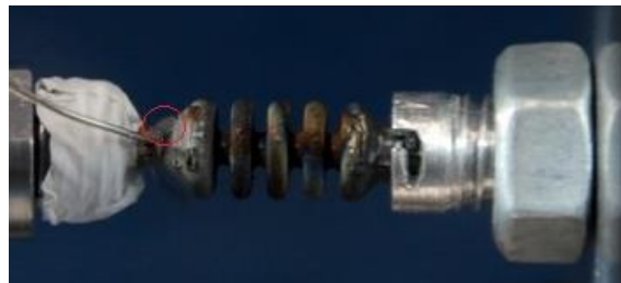
Abb. 5-9: Markierter Bereich zeigt Undichtigkeiten am Hilfsanschluss des Balgaktors
