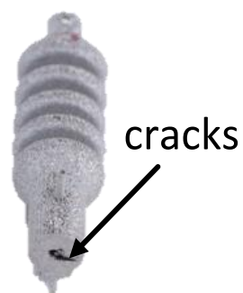
Abb. 5-6: Balgaktor mit Riss an der Stirnseite [59]
