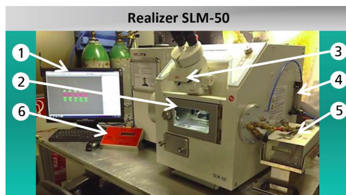
Abb. 4-20: Versuchsaufbau zur Fertigung von Balgaktoren aus Nitinol mit folgenden Bestandteilen: 1) Computer mit Steuersoftware zur Änderung der Prozessparameter, 2) Prozesskammer mit Pulverbeschichtungsanlage und Bauplattform mit einem Durchmesser von 70 mm, 3) Mikroskop zur verbesserten Prozessbeobachtung, 4) Verbesserte Inertgasspülung, 5) Sauerstoffsensoren für konstante Sauerstoffatmosphäre < 30 ppm, 6) Modulationsbox um modulierte Laserstrahlung zu erzeugen [91]
