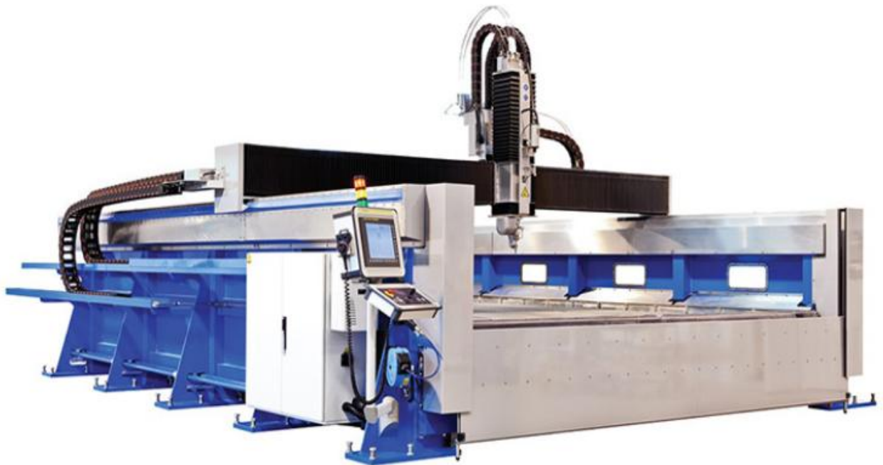
Abb22: 3D Wasserabrasivstrahlschneiden FiveX [10]
