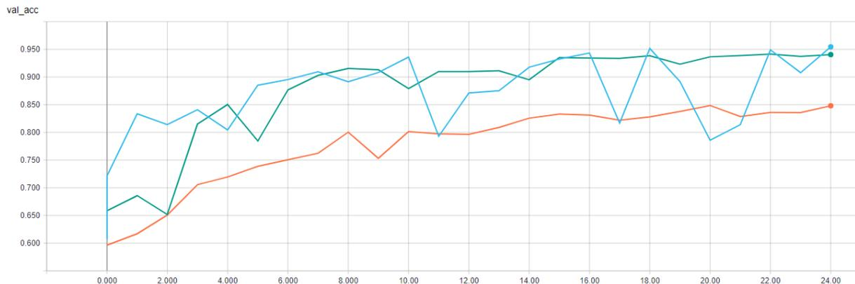
Abbildung 53: Genauigkeit auf dem Validation Set mit der Batch Normalisierung
