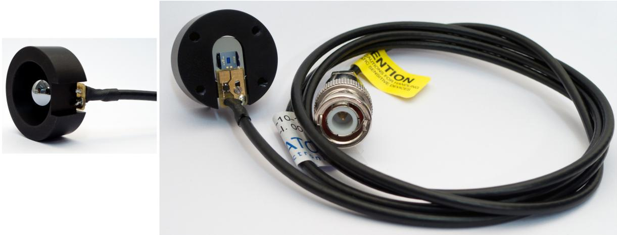
Abb. 5: Vollständig aufgebaute THz-Antenne für einen Freistrahlaufbau; links: Blick auf die Si-Linse zur Auskopplung des THz-Pulses; rechts: Blick auf den Antennenchip und die Platine; Quelle: BATOP GmbH
