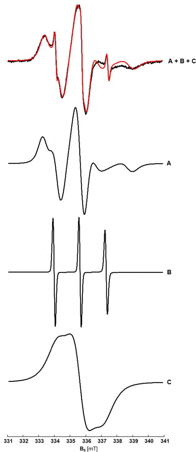
Abb. 59. Spektrale Zusammensetzung einzeln simulierter Komponenten A , B und C des aufgenommenen CW-ESR-Spektrums von \beta BD-61-SL unter HSA-Beteiligung im Verhältnis von 1:1 und einer fixen Proteinkonzentration von 600 \mu M.
