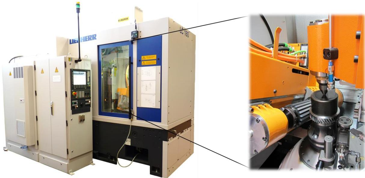
**Bild 4-2** Wälzfräsmaschine LC180 der Fa. Liebherr**Tabelle 2** Technische Daten der Wälzfräsmaschine Liebherr LC 180
