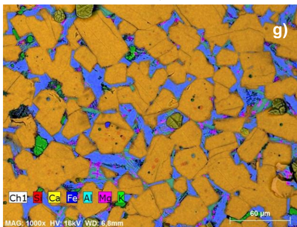
Abbildung 59: EDX-Analysen der Zwischenphase des Klinkers K7 im Vergleich zu den Daten nach Taylor 1997 (a-f); REM-Bild kombiniert mit der mittels EDX-Mapping gewonnen Elementinformation des Klinkeranschliffs K7 g) ; Vergrößerung 1.000fach
