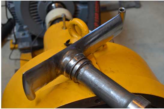
(a) Adaption des Pitot-Rohres zur Trennung mit 2 separaten Ausgängen
