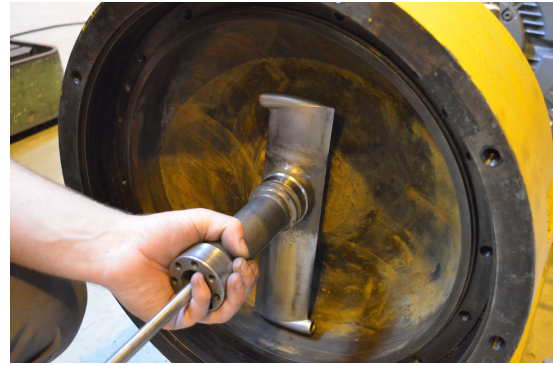
(b) Position des adaptierten Pitot-Rohres im Rotor
