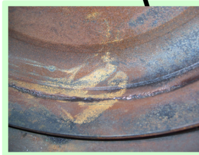
Abbildung 5.15: Lokale Veränderung der Oberflächenbeschaffenheit des Rotors durch Kavitationsschäden zwischen Pitot-Rohr und Rotor mit zunehmender Betriebsdauer: (links) In den ersten Betriebsjahren bilden sich kleine Ausgrabungen in der Rotoroberfläche aus. Diese sind gleichmäßig an der Außenwand des Rotors verteilt (10 Stück). Die Anzahl der Ausgrabungen entspricht der Anzahl an Laufrädern. (rechts) Mit zunehmender Betriebsdauer verbinden sich die Ausgrabungen zu einem einzigen „Kanal“.
