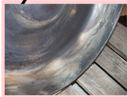
Abbildung 5.15: Lokale Veränderung der Oberflächenbeschaffenheit des Rotors durch Kavitationsschäden zwischen Pitot-Rohr und Rotor mit zunehmender Betriebsdauer: (links) In den ersten Betriebsjahren bilden sich kleine Ausgrabungen in der Rotoroberfläche aus. Diese sind gleichmäßig an der Außenwand des Rotors verteilt (10 Stück). Die Anzahl der Ausgrabungen entspricht der Anzahl an Laufrädern. (rechts) Mit zunehmender Betriebsdauer verbinden sich die Ausgrabungen zu einem einzigen „Kanal“.
