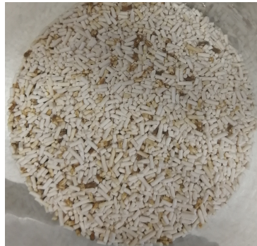
Abbildung 4.10: Nach einem Versuchs-Regenerationszyklus ( T_{\text{reg}} = 120^{\circ}\text{C} ) einer Säule entnommene Partikel HCZP 200E mit deutlich sichtbaren Verfärbungen.
