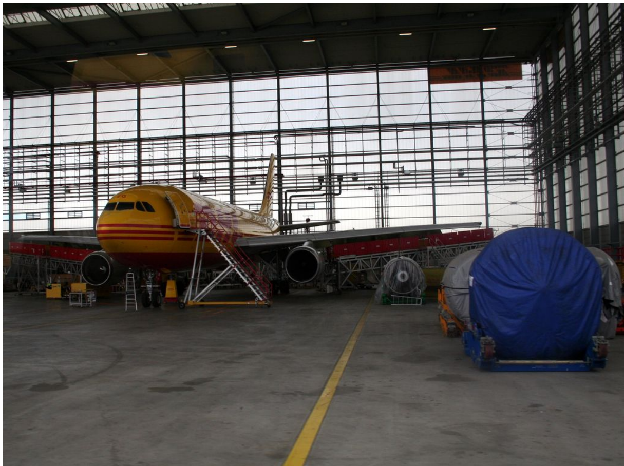
Abbildung 17: Flugzeugwartung mit ausgebauten Ersatztriebwerken
