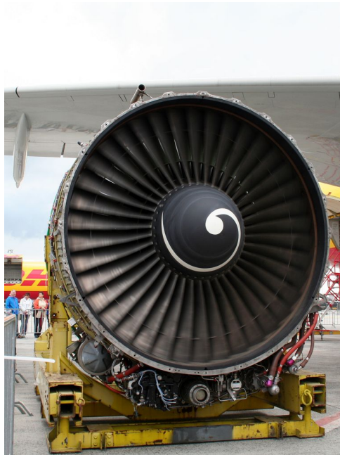
Abbildung 18: Triebwerk ausgebaut und in Transporteinrichtung (Quelle: eigene Fotografie.)
