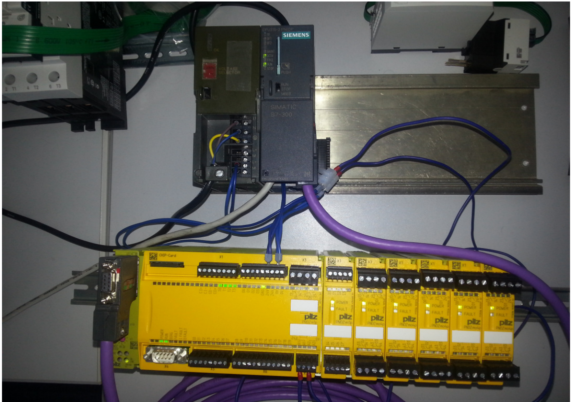
Abbildung 4-28 Versuchsaufbau Profibus mit S7-315 2 PN/DP
