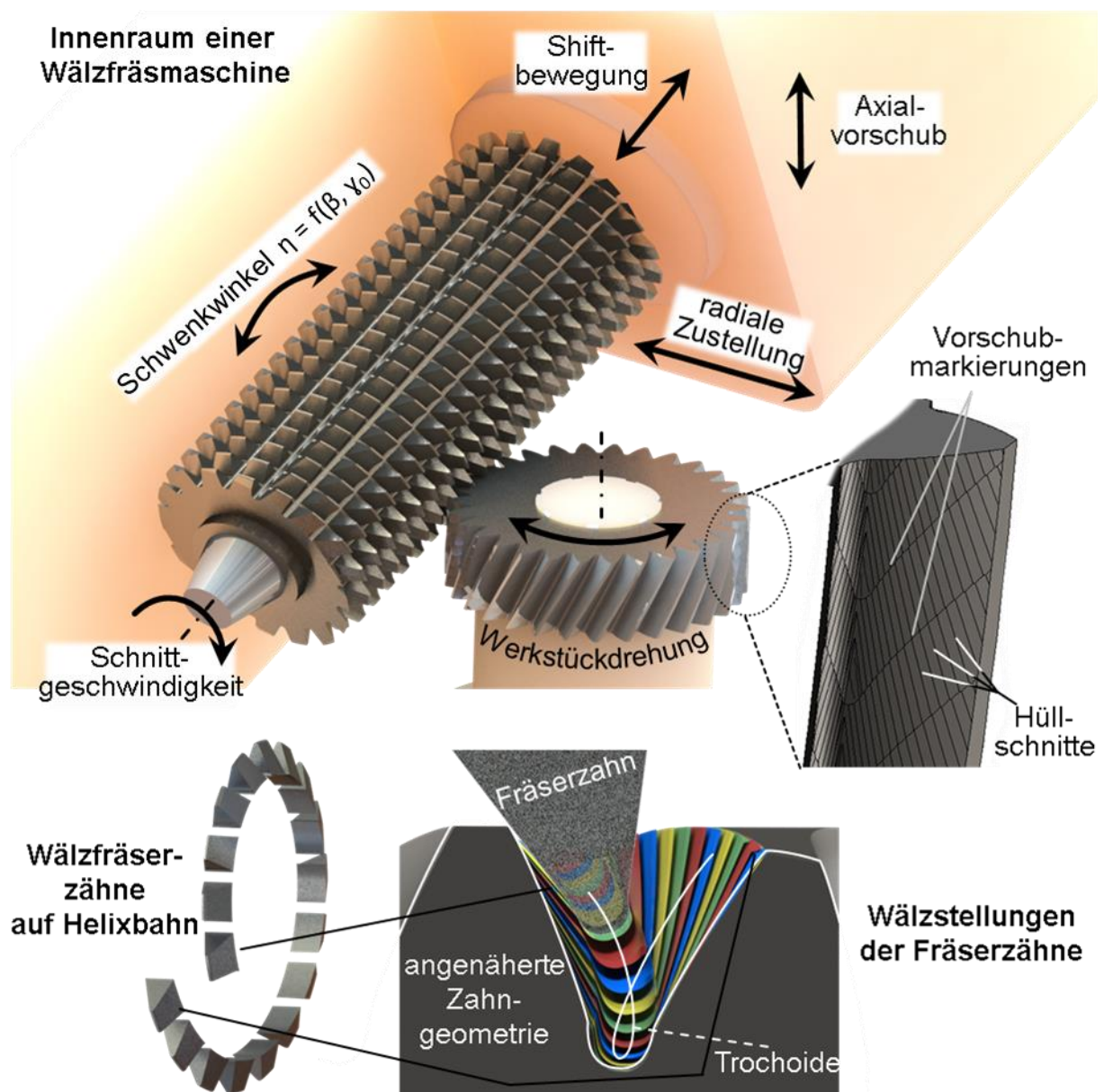
Bild 2.1: Wälzfräsen – Kinematik und Prozesscharakteristik
