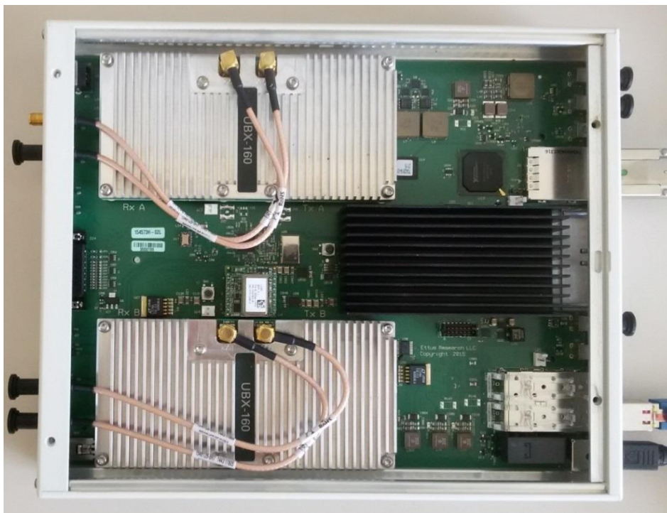
Abbildung 3: USRP X310 mit zwei Erweiterungskarten UBX-160
