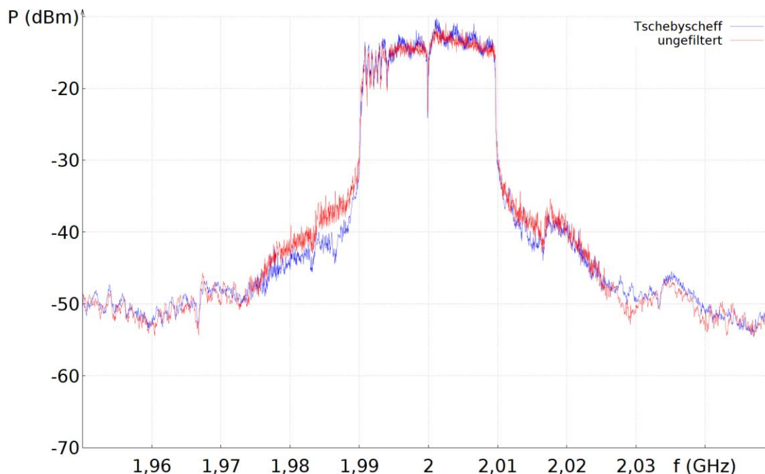
Abbildung 35: Tschebyscheff Tiefpass bei 2 GHz
