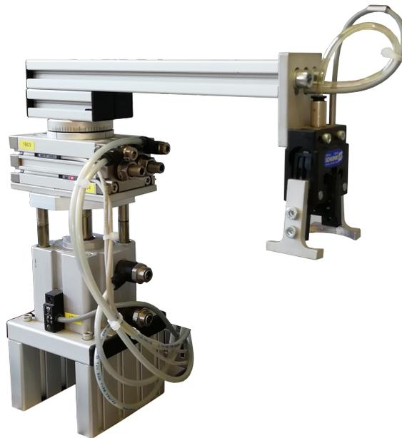
Abbildung 3.4.: Pneumatischer Umsetzer zwischen Band 1 und Band 2
