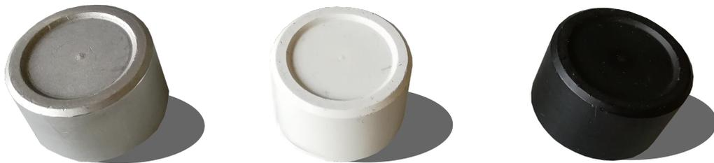
**Abbildung 3.1.:** Verwendete Werkstücke: Aluminium, weißer und schwarzer Kunststoff
