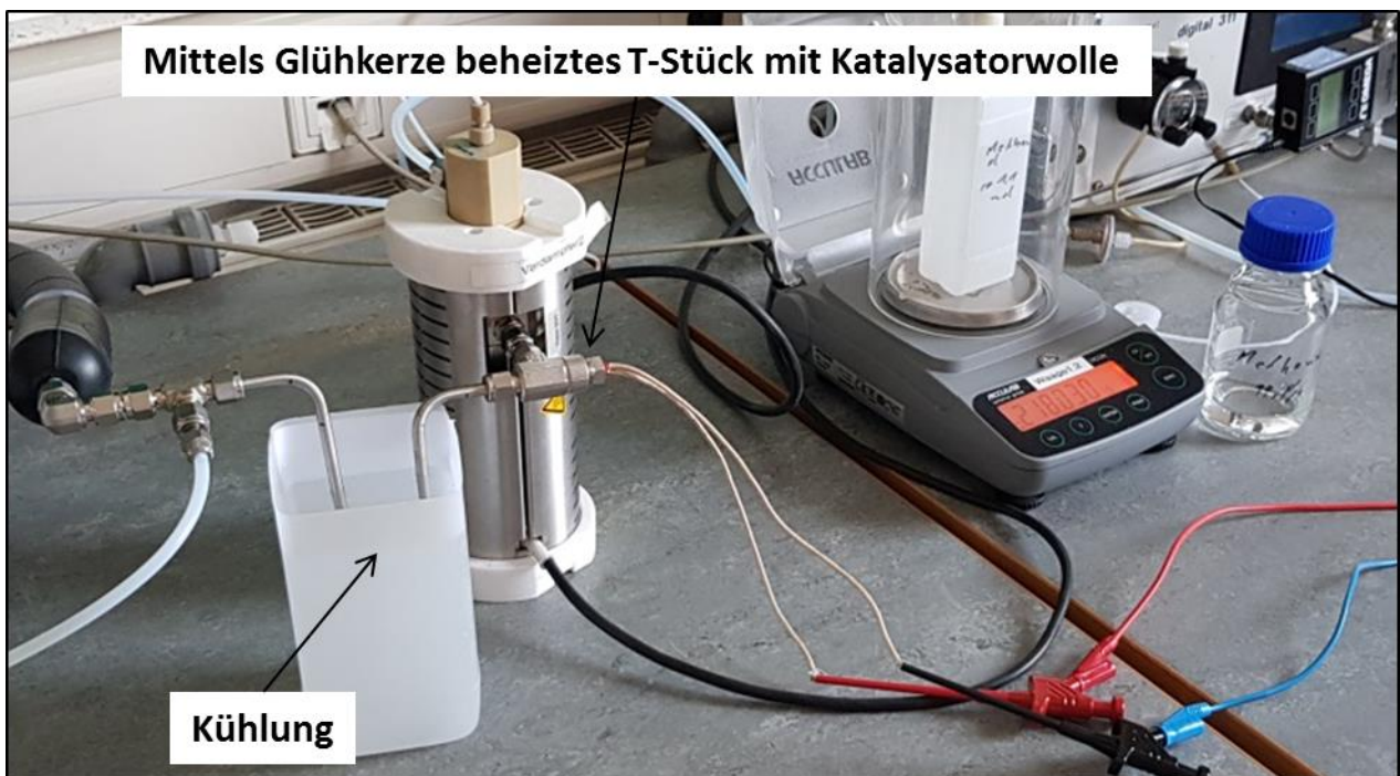
Abb. 6-7: Versuchsaufbau mit Glühkerze und anschließender Messgaskühlung
