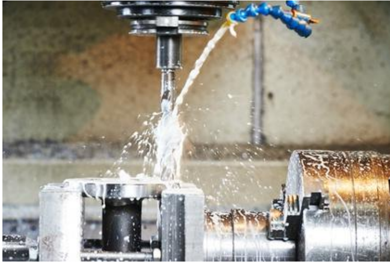
Abb. 34 Kühlsystem und Kühlmittelanlagen [24]
