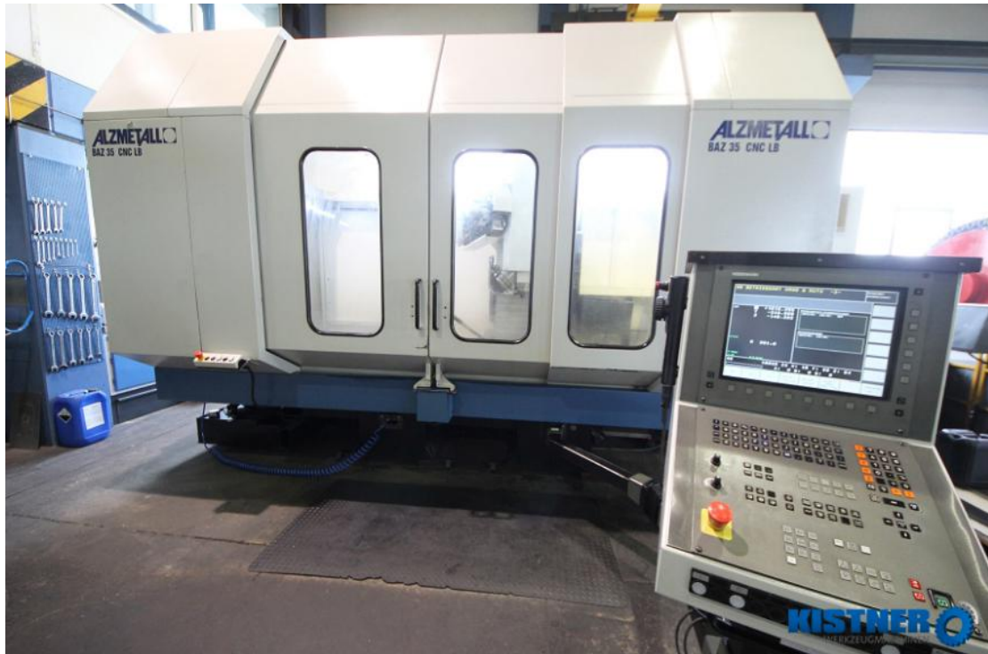
Abb.18 Bearbeitungszentrum BAZ 35 CNC
