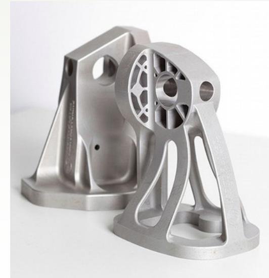
Metallteile, hergestellt im SLS-Verfahren /Mkstech/
