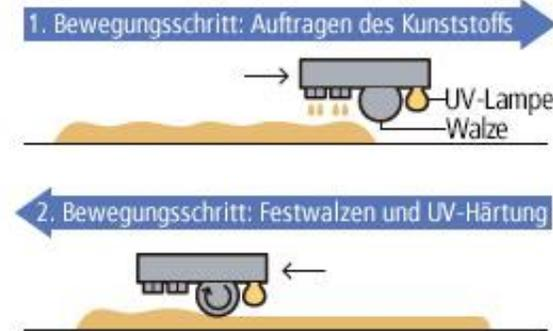
Der Kopf bewegt sich in X- und Y-Richtung über die Druckplatte. Gemäß der durch die Daten für die betreffende Schicht vorgegebenen Form wird ein flüssiges UV Harz tröpfchenweise aufgetragen. Das Material wird mit der neben dem Druckkopf angebrachten UV-Lampe ausgehärtet.
