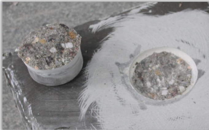
Abbildung 9.5: links der gezogene Prüfstempel eines betonstaubgefüllten Epoxidharzkratzspachtels.
