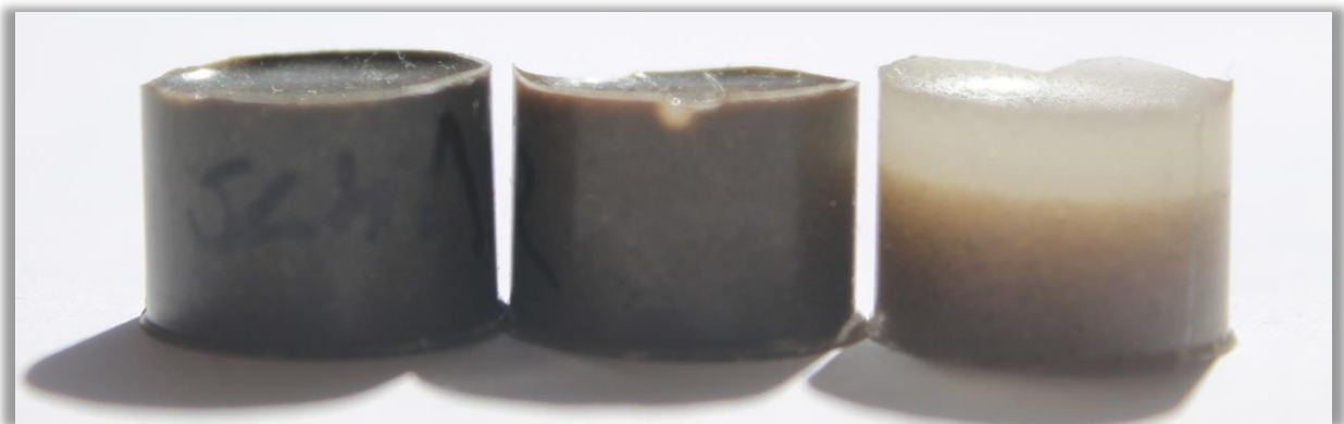
Abbildung 4.2: Zeigt das ausgehärtete Harz mit einer Füllstoffbeladung von 1kg/kg, von links nach rechts: Fräsbetonstaub mit D63,2: 23,67µm, gestrahlter Beton mit D63,2: 65,5µm und Quarzsand mit D63,2: 180µm Korndurchmesser.
