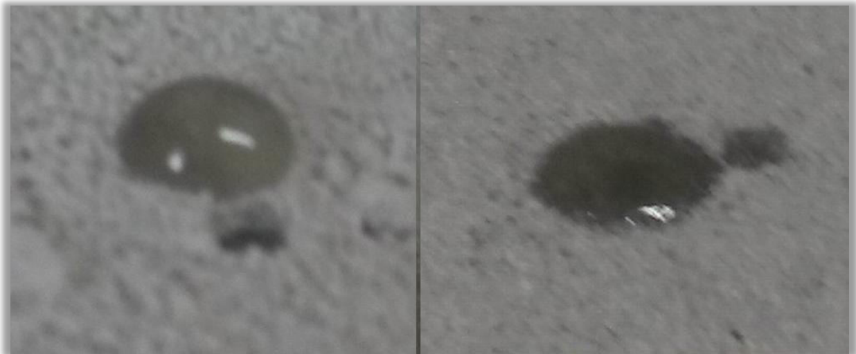
Abbildung 4.13: links Betonstaub mit einem Epoxidharztropfen, rechts Quarzsand mit einem Epoxidharztropfen nach jeweils 30 Sekunden.
