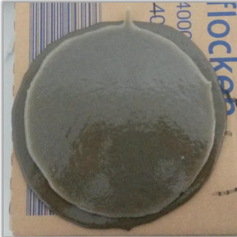
Abbildung 9.4: Außbreitmaß des quarzsandgefüllten Epoxidharzes oben, Ausbreitmaß des mit betonstaubgefüllten Epoxidharzes unten im Vergleich aufeinander gelegt.
