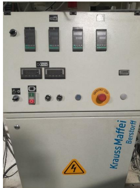
Abbildung 8: Heizungssystem und Drehzahleinstellung des Moduls
