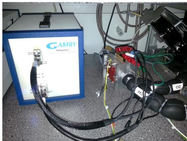
**Abbildung 23: Gamry Reference 3000 mit Reference 30k Booster und Messzelle.**
