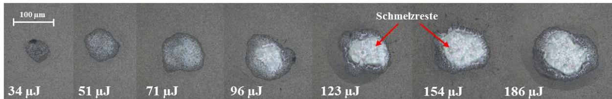
**Abb. 4.21:** Einzelpulse auf Probe 1a(CIGS) (Pulsradius 113,5 mm, Wellenlänge  $\lambda = 1064$  nm, Pulsenergien 34  $\mu$ J bis 186  $\mu$ J); es finden sich in jeden Fall CIGS-Reste am Kraterboden, bei niedrigen Fluenzen finden noch keine vollständige Aufschmelzung des CIGS-Materials statt; bei höheren Fluenzen bilden sich außerhalb der Krater zirkuläre Risse.
