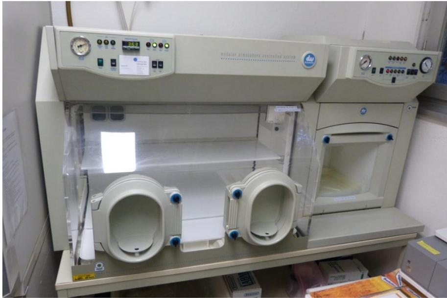
Abbildung 8: Anaerobierbank (Modular Atmosphere Controlled System, MG500, Meinstrup dws, Lähden-Holte, Deutschland)
