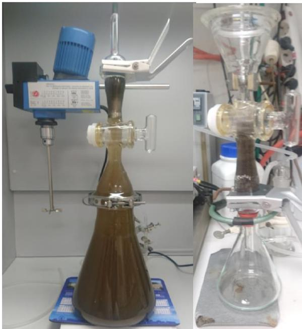
**Abb. 14: Glas-MPSS, Links: Extraktion der Mikroplastik-Fraktion, Rechts: Membranfiltration mit MPSS-Oberteil**
