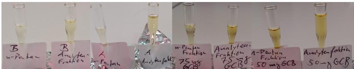
**Abb. 26: Probenextrakte aufgereinigt mit unterschiedlichen GCB-Mengen**
