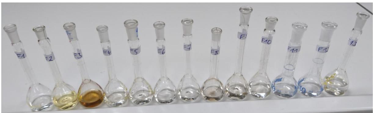
Abb. 24: Elutionsversuch mit DCM/CH<sub>3</sub>OH 3/1 V/V und Probe „Klärwerk DOW Chemical“: Färbung der Eluate
