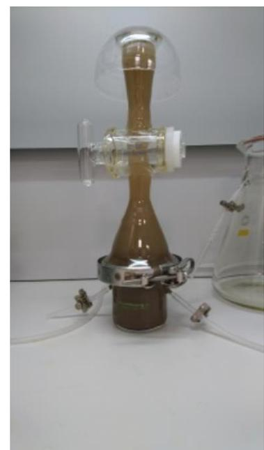
**Abb. 30: Glas-MPSS mit 100 mL Reaktionsgefäß für zweite Dichtentrennung**
