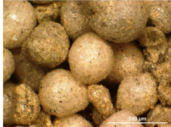
A-1.2: Im Dünnbettmörtel enthaltene Schaumglaskugeln ( x_5 < 500 \mu\text{m} )
