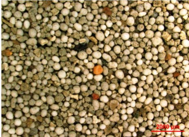
A-1.1: Im Dünnbettmörtel enthaltene Leichtzuschlag-Fraktion ( x_5 < 500 \mu\text{m} )
