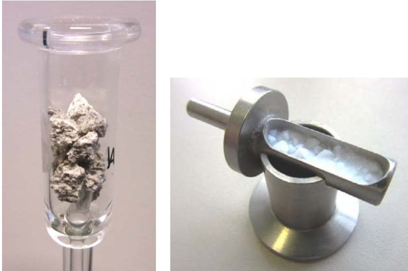
Bild 12: Probenzelle ( 0,5 \text{ cm}^3 Zellenvolumen) befüllt mit Dünnbettmörtel-Bruchstücken (links); Untersuchung einer Pulverprobe (rechts)
