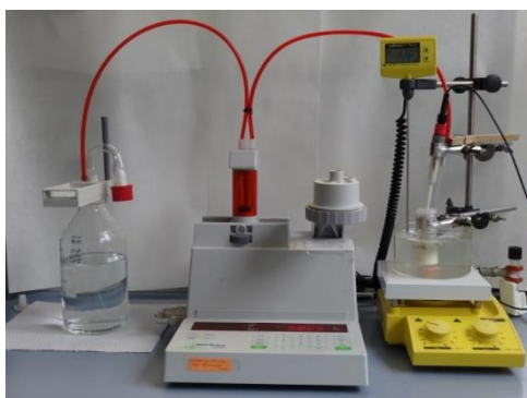
Abb. 9 Aufbau der pH-stat-Apparatur, bestehend aus einem Vorratsgefäß mit NaOH-Maßlösung, Titrereinheit sowie temperierten Reaktionsgefäß mit Medium, Probe und pH-Wert Messung.
