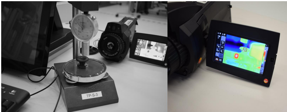
Abbildung 43: Erfassung der Stopfenoberflächentemperatur.
