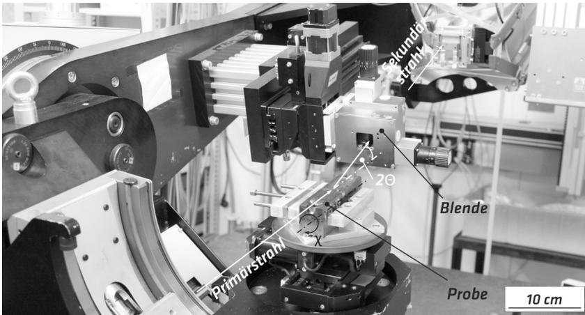
**Bild 3.19:** Versuchsaufbau zur Bewertung der Transversaleigenstressungen über die Schweißnahtoberfläche an der kompakten U-Probe mittels Synchrotronbeugung am EDDI [351], Strahlengang schematisch dargestellt
