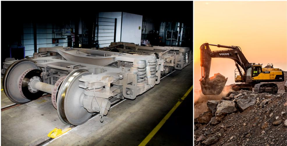
*Bild 1.1: Drehgestelle (links, eigene Aufnahme mit freundlicher Genehmigung von Hr. J. Fischer, Talgo Deutschland GmbH – Standort Berlin, 21.11.2017) und Schaufelarme von Aushubmaschinen (rechts, hier VOLVO Typ EC750D) sind typische Anwendungsbeispiele für Feinkornbaustähle unter zyklischer Beanspruchung; Nutzungsrechte mit freundlicher Genehmigung von Fr. H. Kitchener am 06.07.2017 erteilt. (<http://images.volvoce.com>)*
