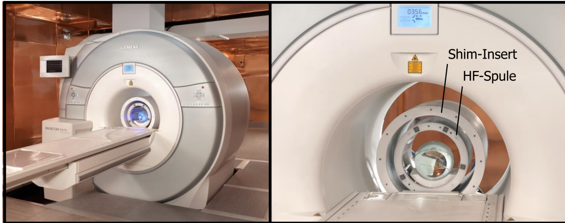
Abb. 2.2: Typischer Messaufbau des Siemens-MR-Tomografen mit eingebrachtem Shim-Insert und HF-Spule.
