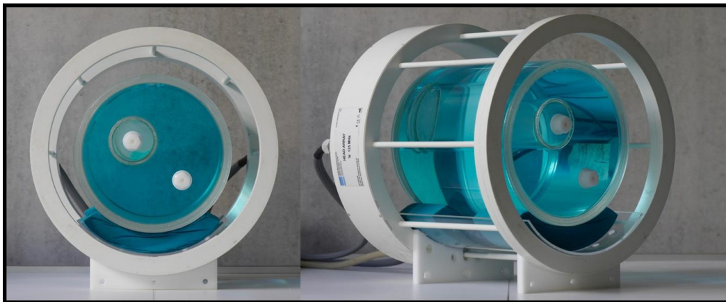
Abb. 2.3: Gezeigt ist das Zwei-Kompartiment-Phantom in der 8-Kanal-Spule
