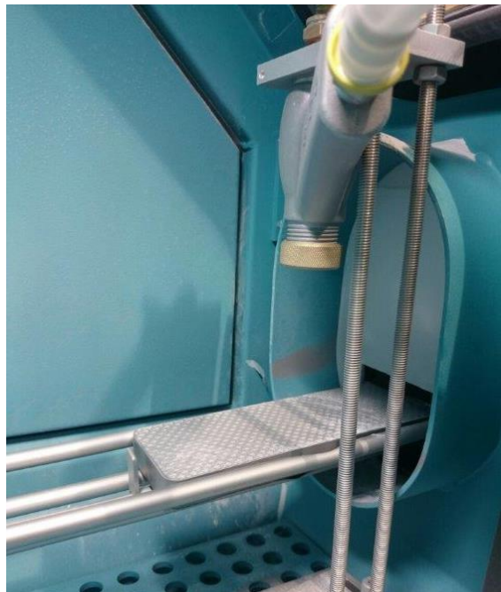
Bild 10.16: Versuchsaufbau zum teilautomatisierten Strahlverschleiß mit Glasbruch
