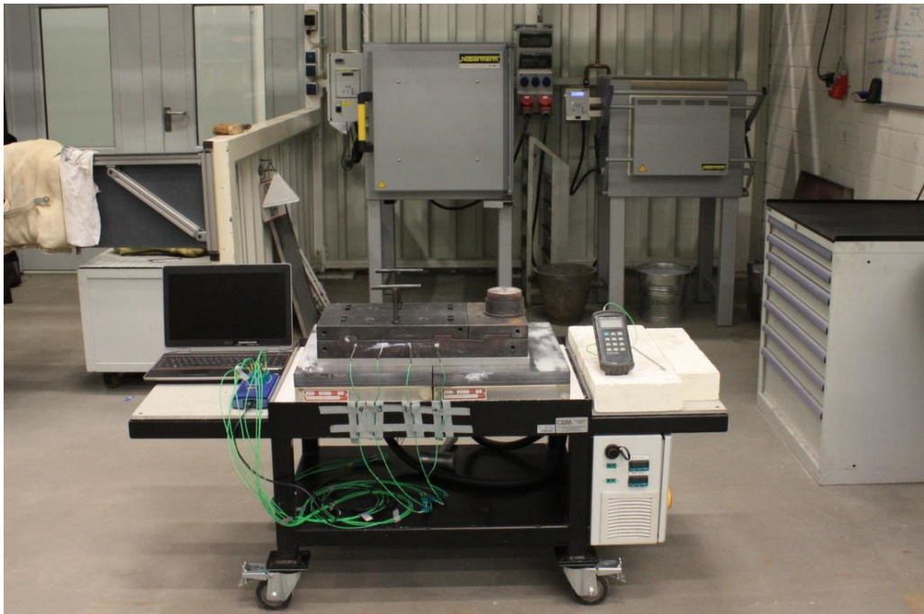
Bild 5.4: Gießplatz mit der modularen Kokille und Messtechnik
