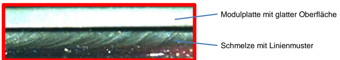
Bild 6.13: Detailansicht HS-V01 mit glatter Oberfläche und möglicher Oxidhaut (Linienmuster)
