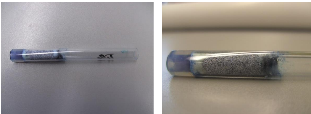
Abbildung 3-5: Glasröhrchen mit pulverförmigen Katalysator
