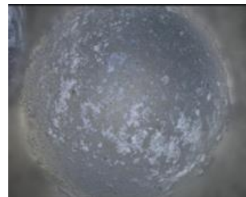
Abbildung 6-5: Mikroskopische Aufnahme einer Glaskugel, die mit S3 bei 10 mm/s beschichtet wurde
