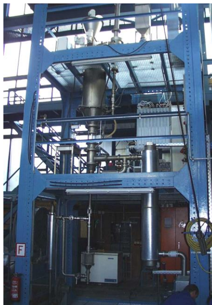
Abbildung 3-2: Darstellung der Wirbelschichtapparatur
