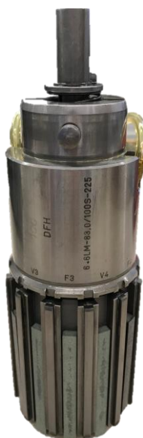
Bild 4.4: Doppelaufweitendes Fertighonwerkzeug Fa. DFH
