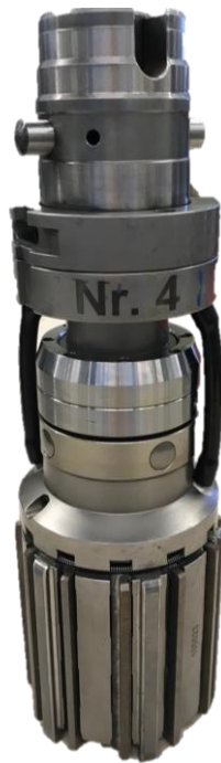
Bild 4.3: Doppelaufweitendes Fertighonwerkzeug Fa. Nagel
