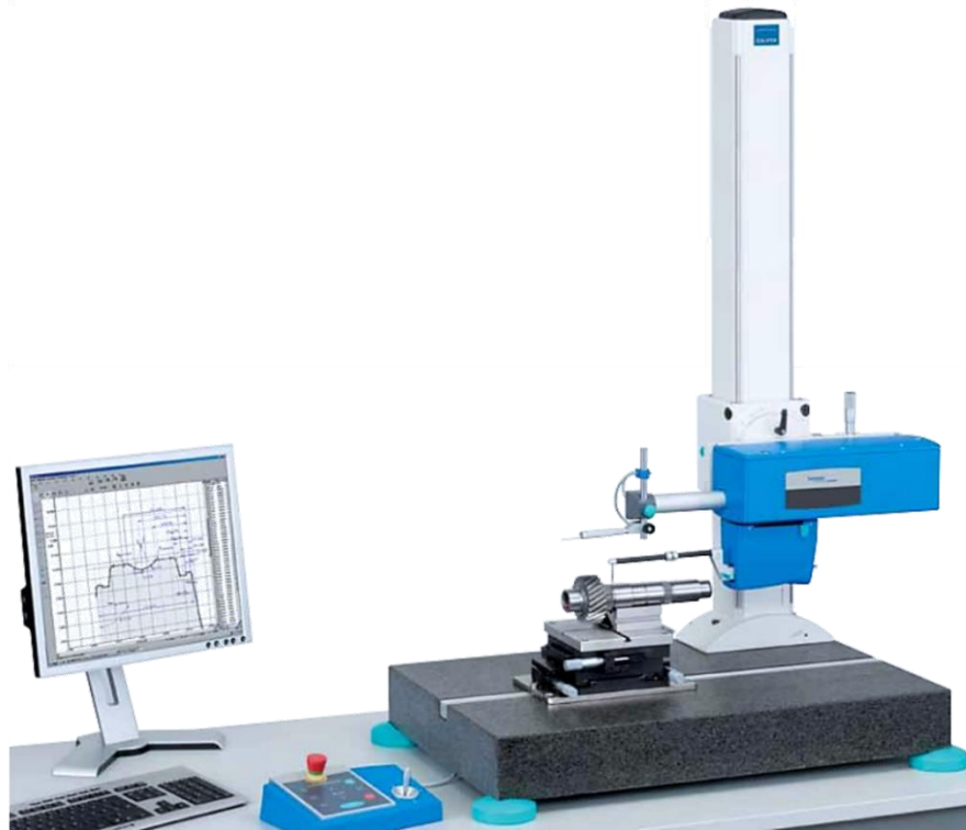
Bild 4.12: Rauheitsmessgerät Hommel T8000
