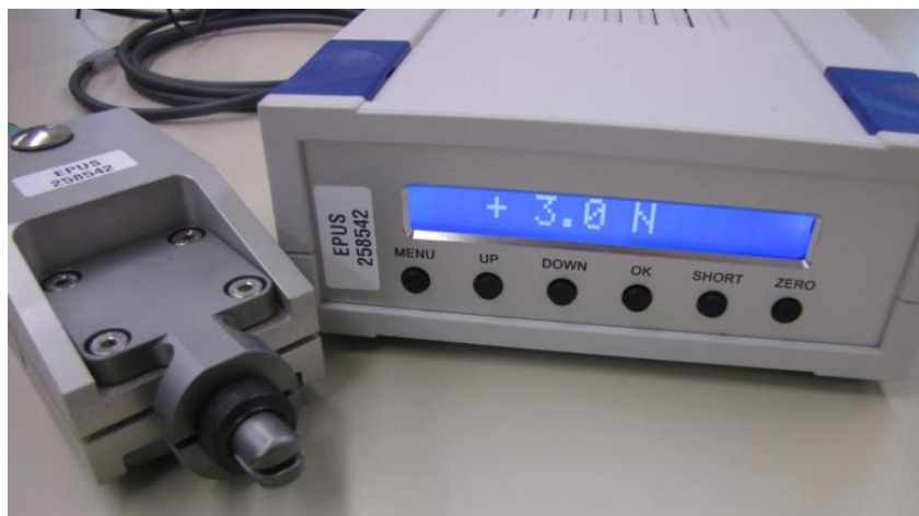
Abbildung 5.3: Radialkraftmesseinheit zur Bestimmung der Vorspannkraft des Dichtrings nach [79]
