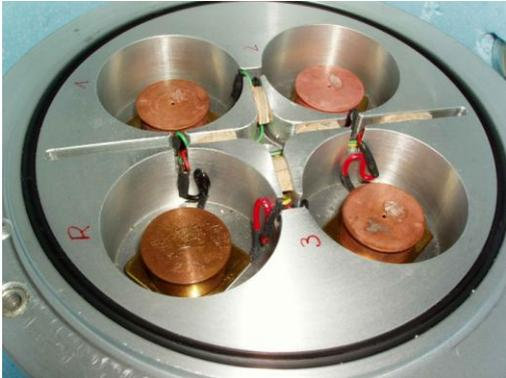
**Abb. 15:** Messzellen des Wärmeflusskalorimeters, bestückt mit Cu-Tiegeln für die *Einspritz-Methode*.
