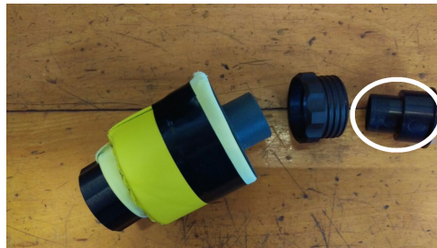
Abbildung 5.4: Schalldämpfer des Gebläsefilteranzuges mit Verbindungselement
