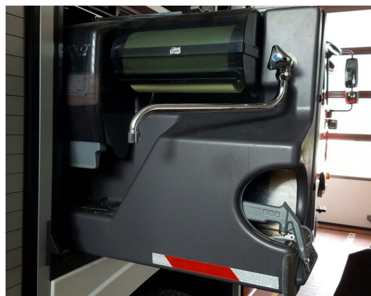
Abbildung 6.3: Beispielhaftes Hygieneboard eines Löschfahrzeuges
