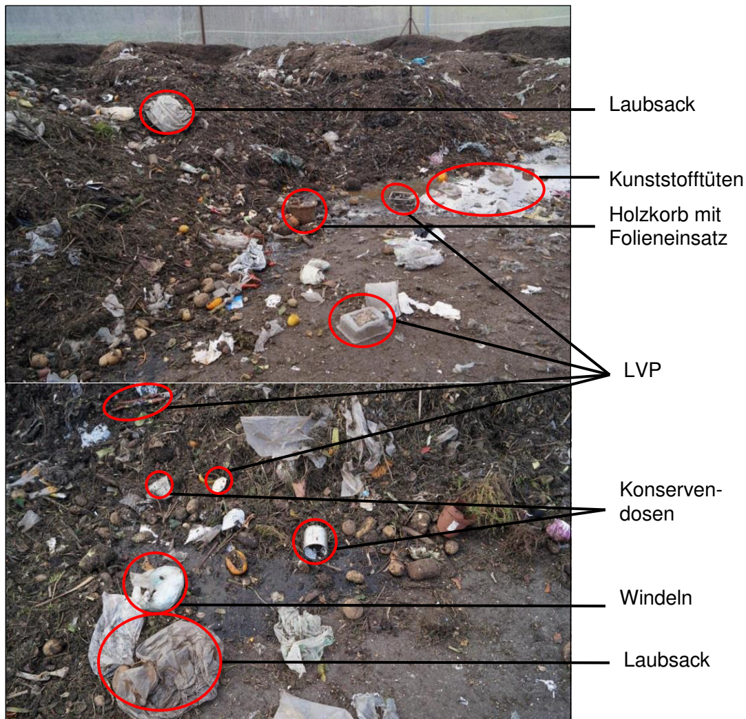
Abbildung 14: fremdstoffbelasteter Bioabfall [Kompostierungsanlage Fohrde 2017].
