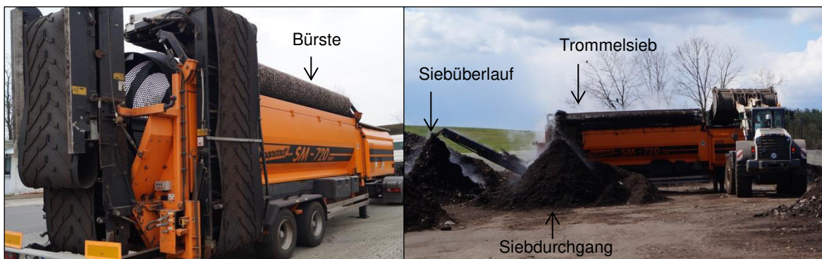
Abbildung 10: mobiles Trommelsieb mit Bürste (links), Siebvorgang (rechts) [Kompostierungsanlage Fohrde 2017].
