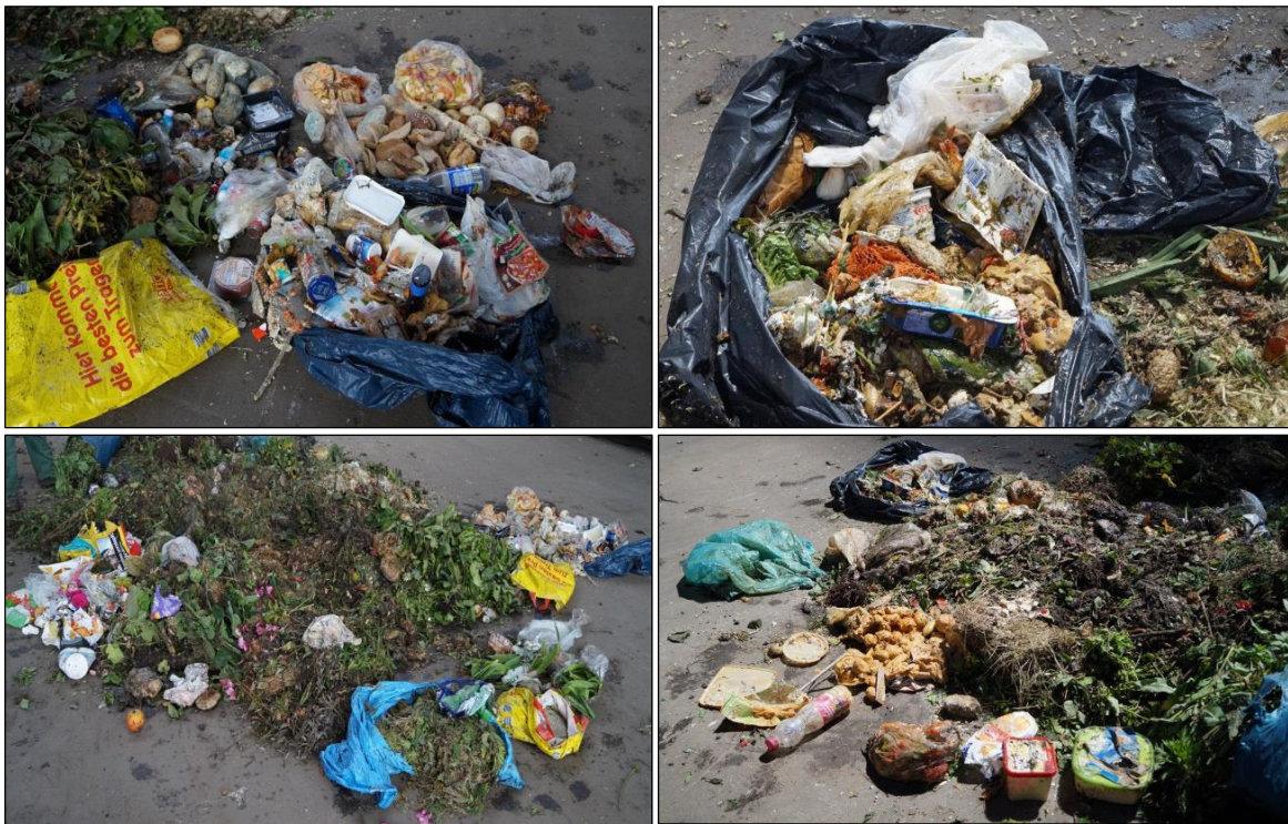
Abbildung 5: fremdstoffbelasteter Bioabfall aus dem Stichprobengebiet der GWA [Recyclingpark Brandenburg 2017].
